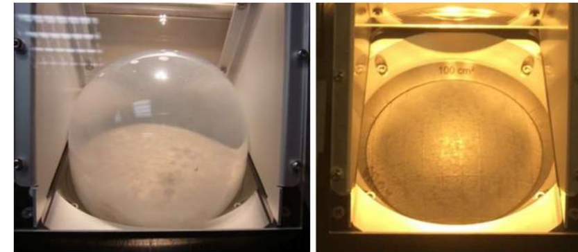
Abbildung 2: Zwei Proben unterschiedlicher Produkte während der Prüfung zur Bestimmung der Höhe der dynamischen Wassersäule; Bei der linken Probe traten bereits während des Martindale-Verfahrens Delaminierungen von Vlies und TPU-Beschichtung auf, die zusammen mit Beschädigungen der oberseitigen TPU-Beschichtung zu der deutlich erkennbaren „Wasserblasenbildung“ führte; In der rechten Abbildung ist die deutliche Aufwölbung einer dichten Probe nach dem Martindale-Verfahren bei einer Wassersäulenhöhe von ca. 10 m zu sehen
