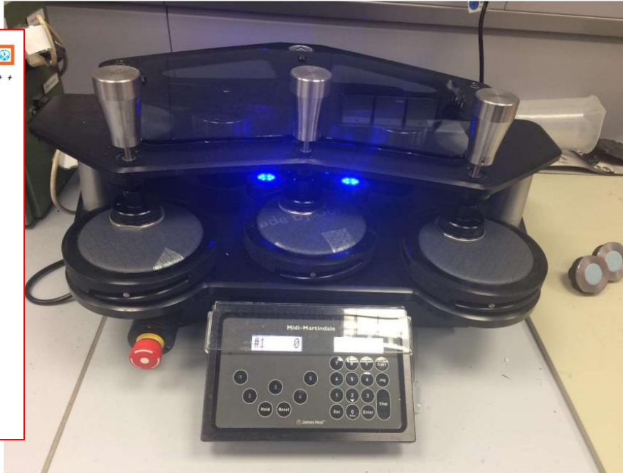
Abbildung 1: Parallele Durchführung des Martindale-Verfahrens an drei Mustern einer Unterdeckbahn
